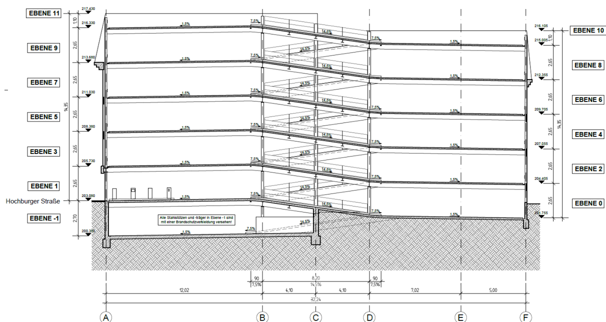
Abbildung 1 Schnitt durch das Parkhaus Stadtmittle in Emmendingen
